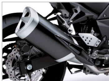
Sistema di scarico
